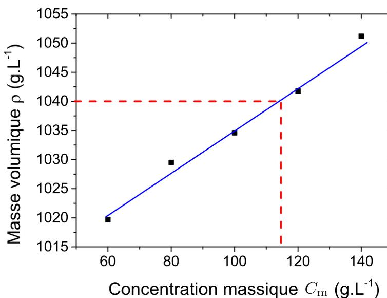
En connaissant la masse volumique  $\rho_{\text{solution}} = 1040 \text{ g.L}^{-1}$  d'une solution inconnue, il est alors possible de la déterminer en utilisant la courbe d'étalonnage. Par exemple, on trouve ici  $C_{m,\text{solution inconnue}} \approx \underline{\hspace{2cm}} \text{ g.L}^{-1}$ .
